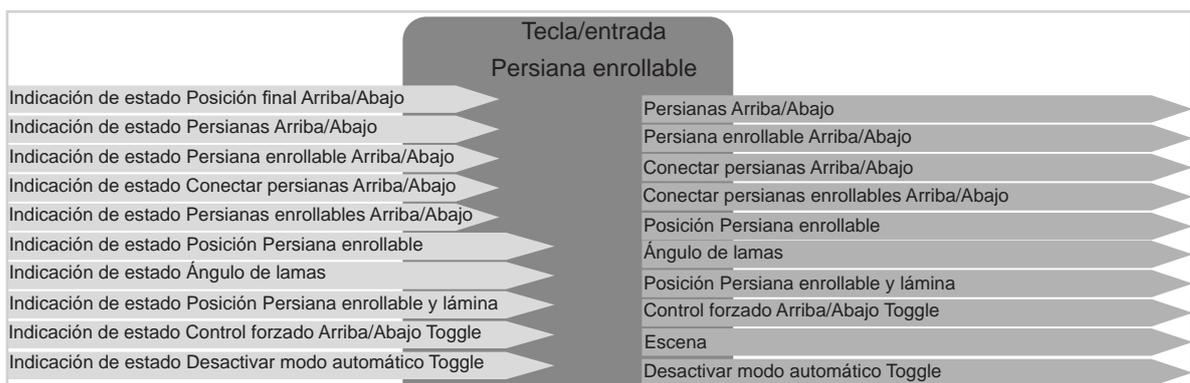
Figura 8: Señales de entrada/salida Función Persiana enrollable
